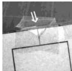
↑写真12 箱組み中 ↑写真13 合わせマーク (9) 床板を貼りつけ、車体を筒型にします。車体中央の合わせマークを合わせるとともに、筒状の車体が両端で捻じれないよう注意して下さい。
