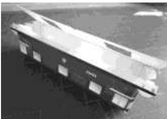
↑写真12 箱組み中 ↑写真13 合わせマーク (9) 床板を貼りつけ、車体を筒型にします。車体中央の合わせマークを合わせるとともに、筒状の車体が両端で捻じれないよう注意して下さい。
